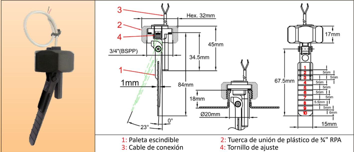
**Usos principales:** El interruptor de flujo más simple con retroceso magnético. La posición de montaje recomendada es en tuberías horizontales, pero se puede montar en cualquier posición. Para la detección de flujo de agua en tuberías de agua con **diámetro de 25 a 100 mm**.
